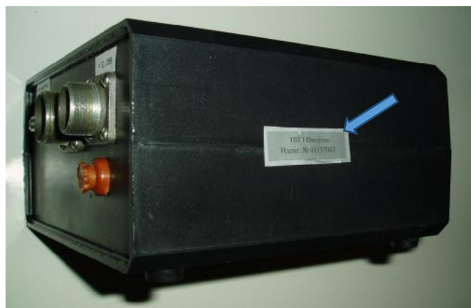
Рисунок 5 – Место пломбировки электронного прибора МС-75
