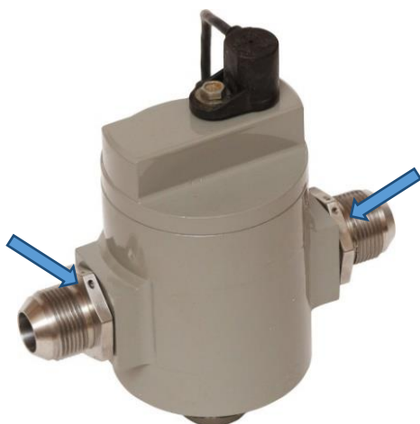
Рисунок 6 – Места пломбировки первичных преобразователей ОР-2\40\100-Э1, Т1
